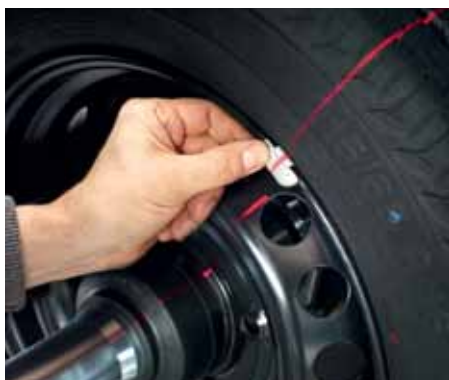
Linienlaser zur exakten Positionierung der Schlaggewichte an Stahlfelgen außen
