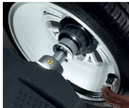
LED leuchtet automatisch bei Einsatz des elektronischen Datenarmes
