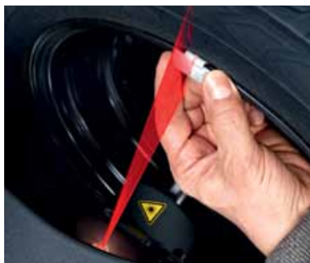
Linienlaser für Schlaggewichte an Stahlfelgen innen
