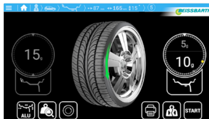
Versteckte Gewichtsverteilung hinter Speichen (SPLIT Programm/ASD-Funktion)
