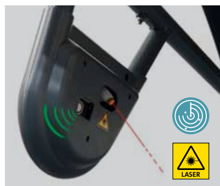
Sonar erfasst automatisch die Breite von Stahlfelgen und die Speichenanzahl bei Alufelgen
