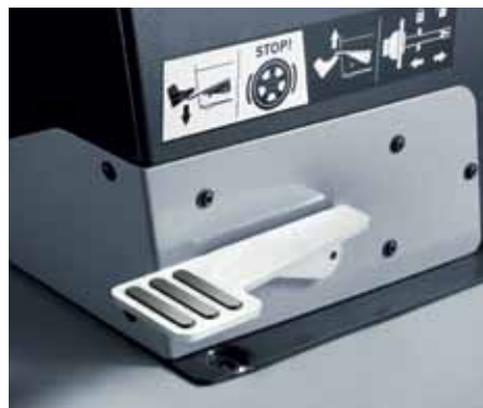
Neue Pedalfunktion: Nach unten: Blockiert Welle/Rad. Hoch: löst/spannt den Pneumatikflansch
