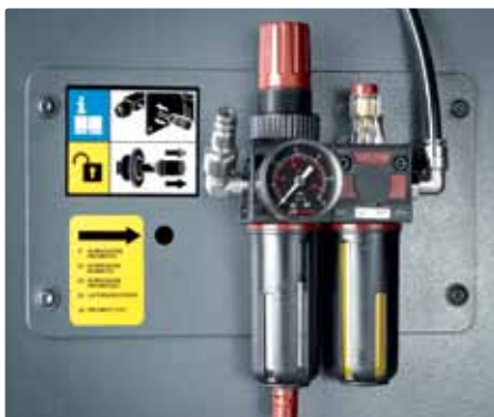
Servicebox: Manuelle Entriegelung und Druckluftanschluss an der Wartungseinheit
