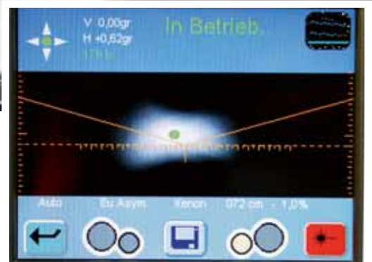
CMOS-Kamera für digitale Bildverarbeitung: Exakte Definition der Hell-Dunkel-Grenze
