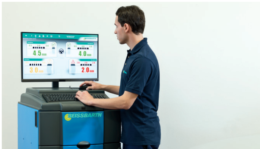
Optimaler Fahrwagen mit PC: schnelle Messung durch direkten Zugriff auf Kundendaten, Messwerte und zentrale Datenablage.
